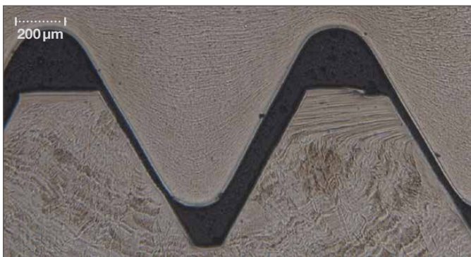
Der Schnitt durch eine Verbindung (austenitische Mutter und Schraube) zeigt die uniforme Behandlung durch BORINOX®. Die erzeugte Diffusionszone schützt vor Kaltverschweißen/Fressen.
